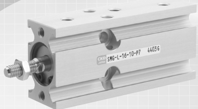
클린 사양(SMG-P7※/P5※ 시리즈) 클린룸 내의 발진을 억제(P7) 및 구리, 실리콘, 할로겐계-재료 미사용(P5)
